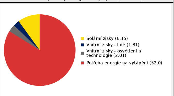
Bilance potřeby energie na vytápění (MWh/rok)
